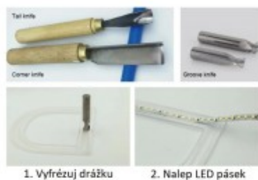
1. Vyfrézuj drážku 2. Nalep LED pásek
