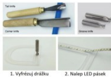
1. Vyfrézuj drážku 2. Nalep LED pásek
